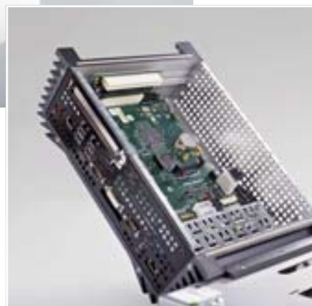
Die Embedded-Control-Plattform basiert auf CPU-Modulen mit COM-Express-Formfaktor
