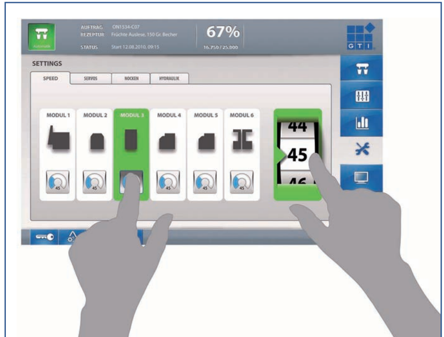
Zweihand-Bedienung: Die Aktivierung einer Maschinen-Funktion und gleichzeitige Werte-Änderung wird die am meisten genutzte Multitouch-Funktion.
